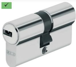
6 pitones combinados con contra-pitones anti-ganzúa. 5 llaves de puntos reversibles de latón cromado XL. Protección anti-taladro con contra-pitón de acero endurecido. Tarjeta de código de propiedad incluida. Muelles fabricados a partir de materiales no corrosivos. Leva de acero sinterizado para una buena resistencia contra la corrosión. Disponible en llaves iguales y otros grupos de llaves iguales. PS: pre-snap (rotura programada por ambos lados).
