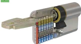
Solución básica adecuada para accesos comunes y de vivienda. Protecciones anti-taladro, anti-bump y anti-ganzúa. Resistencia: 100.000 ciclos. 6 pitones cargados a muelle. Se sirve con 5 llaves de latón níquelado por cilindro. Amplia gama de medidas y perfiles. Acabado: latón y níquel. Certificado según la norma EN-1303.
